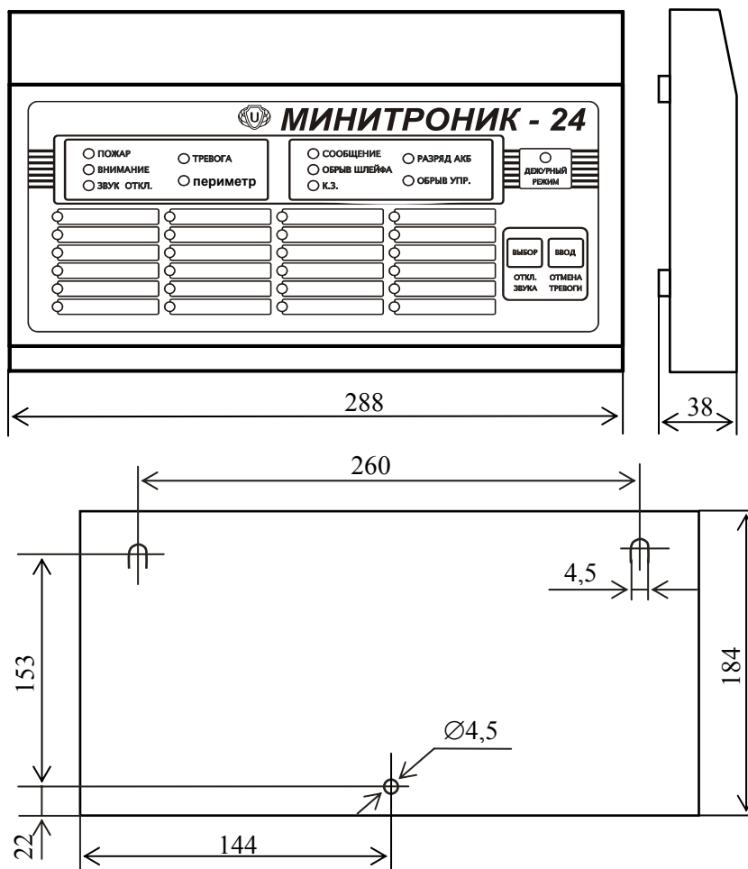
Рис.2. Габаритный чертеж и установочные размеры ПКП.
