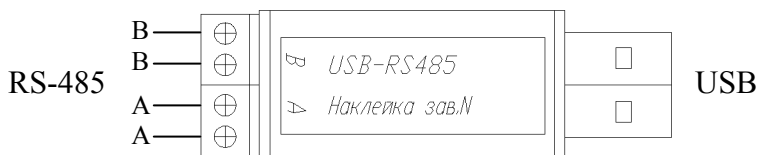
Рисунок 1 Схема подключения «USB-RS485»
