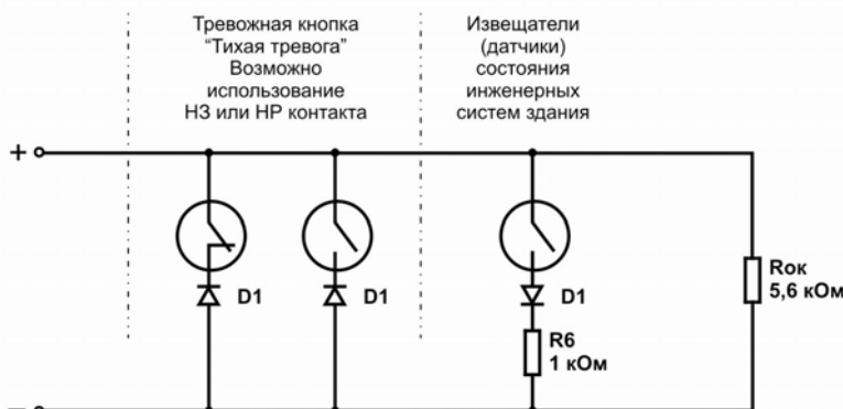
Рис.6. Схемы электрические принципиальные двух вариантов подключения охранного ШС.
