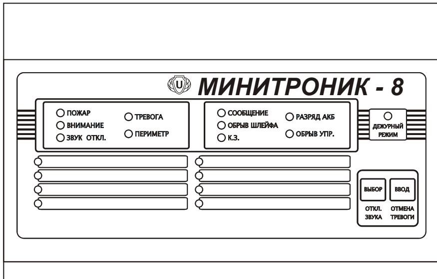
Рис.1. Внешний вид приемно-контрольного охранно-пожарного прибора "Минитроник 8".
