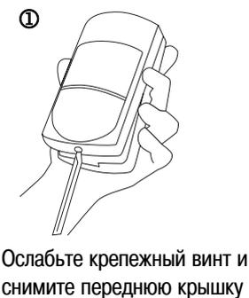
Ослабьте крепежный винт и снимите переднюю крышку
