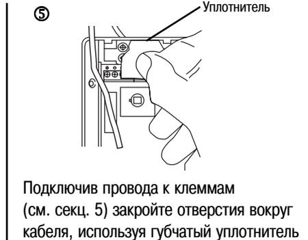
Подключив провода к клеммам (см. секц. 5) закройте отверстия вокруг кабеля, используя губчатый уплотнитель
