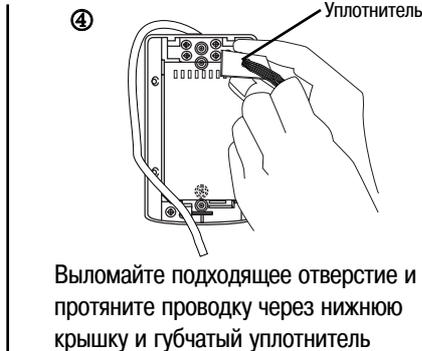
Выломайте подходящее отверстие и протяните проводку через нижнюю крышку и губчатый уплотнитель
